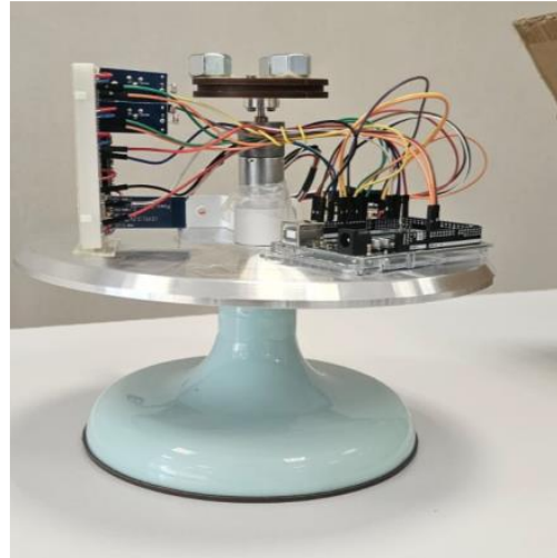
Figura 15. Prototipo final del subsistema de estabilización de un nanosatélite CubeSat en un solo eje.
