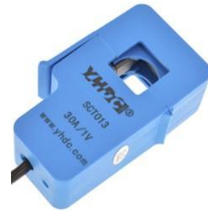
Figura 3. Sensor de corriente sin contacto con adaptador directo a la entrada analógica de la tarjeta de adquisición de datos (arduino) [13]
