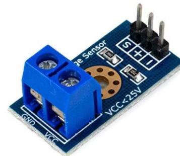
Figura 4. Sensor de voltaje para medición de 0-25 volts [14]
