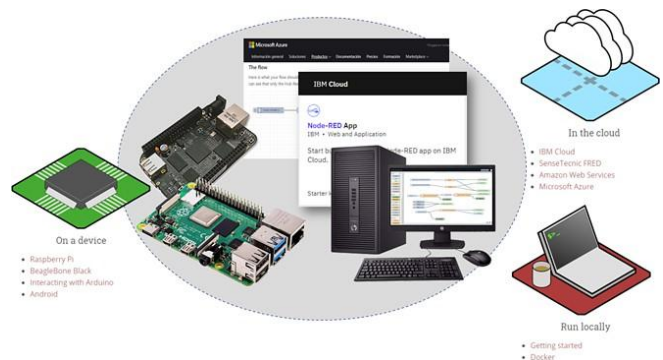
Figura 1. Plataformas de hardware para Internet de las Cosas con NodeRED [9].
