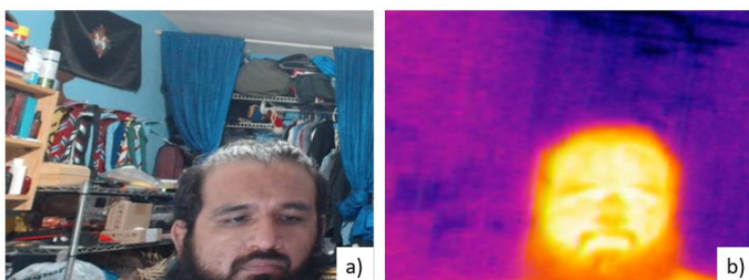
Figura 5.- Imágenes de la a) cámara de video a color y del b) sensor térmico obtenidas después del proceso de rectificación.
