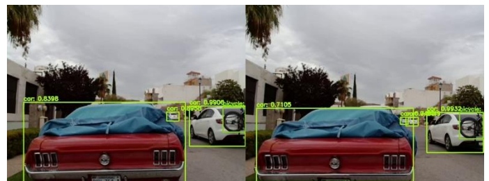
Figura 3.- Vehículos detectados por YOLOv4 en un par de imágenes en estéreo.
