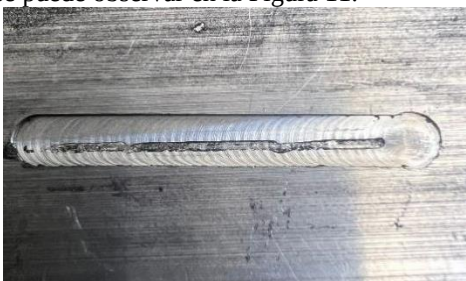
Figura 11. Placa de aluminio con la técnica de FSP
