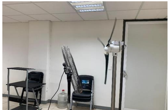
Figura 12. Aerogenerador frente a ventilador.
