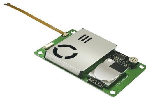
Fig. 3. Sensor de calidad del aire AM1008W.
