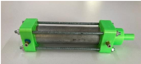
Figura 4. Prototipo final del cilindro de doble efecto fabricado.
