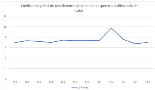
Grafica No.4 Comportamiento del coeficiente global de transferencia de calor con respecto a la diferencia de calor de la muestra color amarillo.
