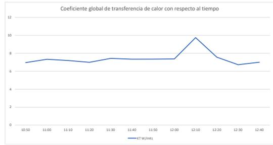
Grafica No: 3 Comportamiento del coeficiente global de transferencia de calor con respecto al tiempo de la muestra color amarillo.
