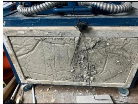
Figura No.7 Maquina térmica con bastidor con una muestra de emplaste convencional, para su caracterización térmica.
