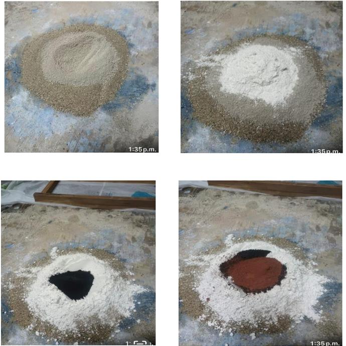
Figura No.3 .Mezcla convencional, mezclas diatérmicas con cal y agregado a base de hule molido de llanta y una muestra diatérmica con pigmento colorante café.
