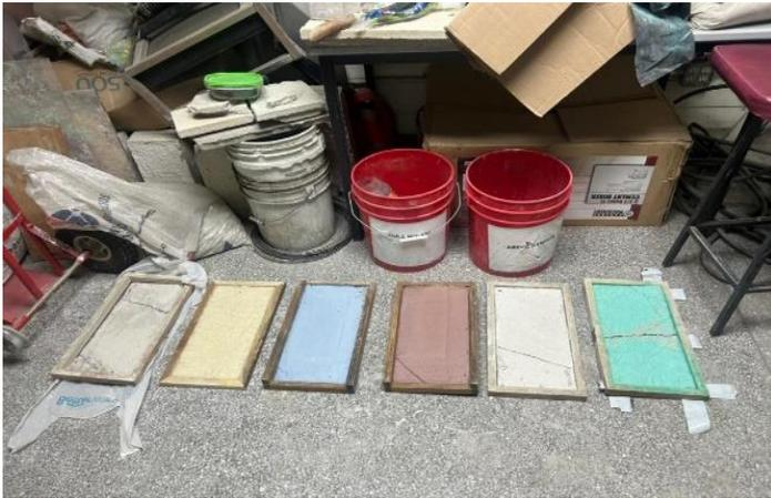
Figura No.5 Las seis muestras en base seca, de emplastes, para su caracterización en la maquina térmica.
