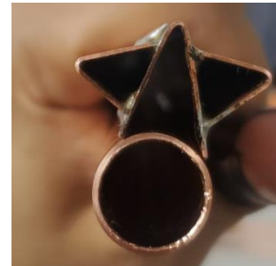
Figura 6, vista frontal del tubo con la primer aleta fractal soldada.
