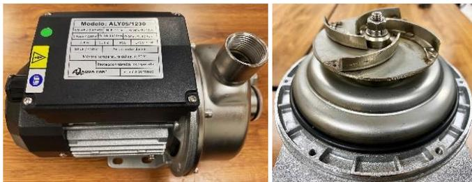
Figura 1.- Bomba centrífuga del análisis, con impulsor semiabierto de flujo radial.
