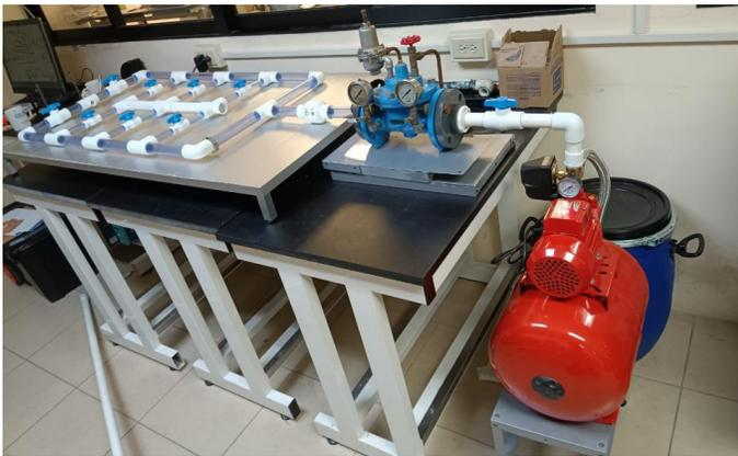
Figura 2. Red de distribución de agua a tamaño escala para pruebas a nivel laboratorio.
