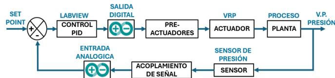
Figura 6. Esquema control PID de presión en lazo cerrado.
