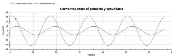
Fig. 8 Resultado de la respuesta de la ecuación de corriente del primario y secundario del transformador, que valida el comportamiento de su ecuación diferencial.
