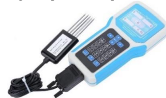
Figura 6. Detector de suelo utilizado para obtención de datos de pH.
