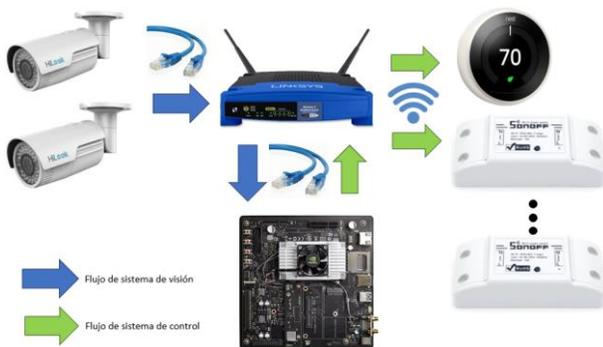
Figura 9.- Conexión en red de los dispositivos del sistema.
