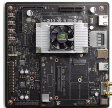
Figura 8.- Tarjeta Nvidia Jetson TX2.
