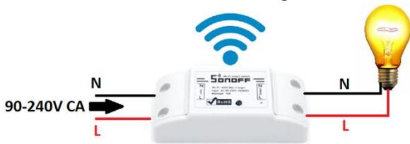
Figura 6.-Diagrama de conexión eléctrica del interruptor Sonoff Basic.
