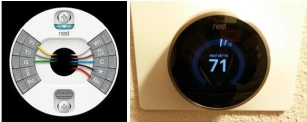
Figura 7.- Termostato Nest. a) Diagrama de conexión y b) Dispositivo instalado en el área de prueba.
