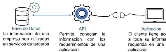
Figura 1. Ejemplo de funcionamiento de una API. Fuente [6]
