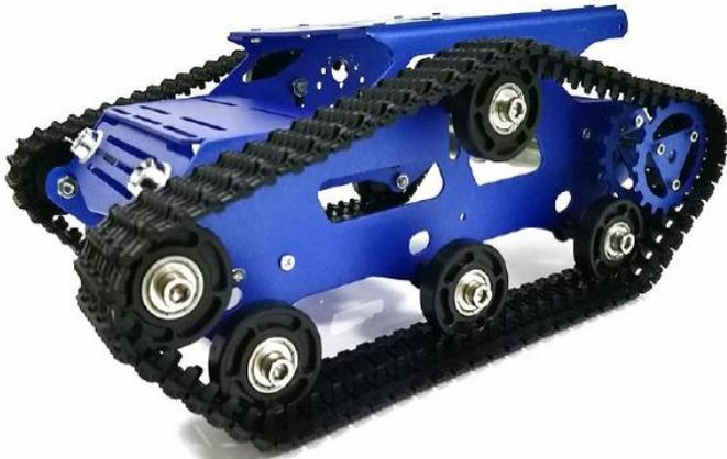
Fig. 9. Chasis Robot Oruga. Elaboración propia.
