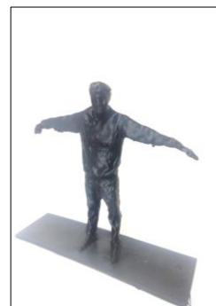
Figura 7.- Modelo 3D de la primera persona de la Tabla 4 generado con la impresora Ender 3 Pro.
