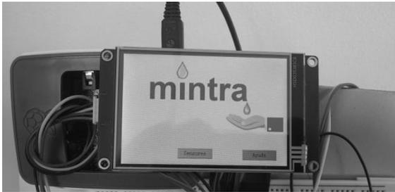
Figura 10. Pantalla HMI para monitoreo.
