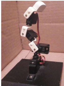
Figura 4 Mini-robot antropomórfico de cuatro grados de libertad.
